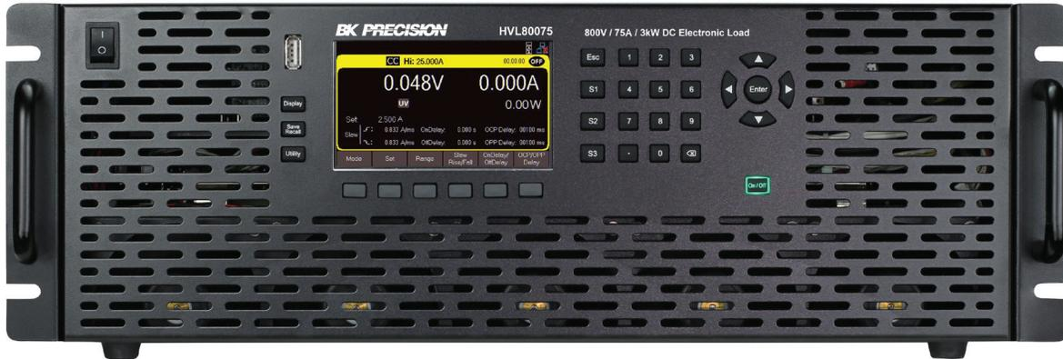
Las Cargas Electrónicas DC Programables Alto Voltaje de la Serie HVL ofrecen hasta 1000 V de voltaje operativo. Adecuada para aplicaciones de mesa o de montaje en rack, esta serie admite una amplia variedad de condiciones de carga dinámica con velocidades de giro de subida/bajada ajustables, modo lista y opciones de disparo flexibles.
