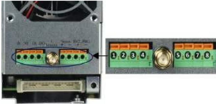
Figure 6.15 Bornes sur le panneau arrière du module à une voie
