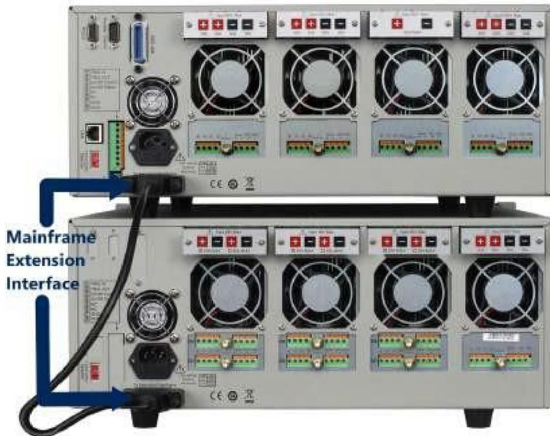
Figure 5.5 Connexion de l'extension de l'unité centrale
