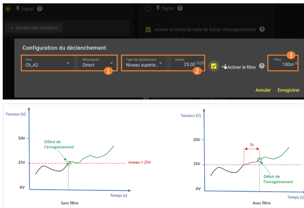
FIGURE 3.26 : Déclenchement sur niveau
