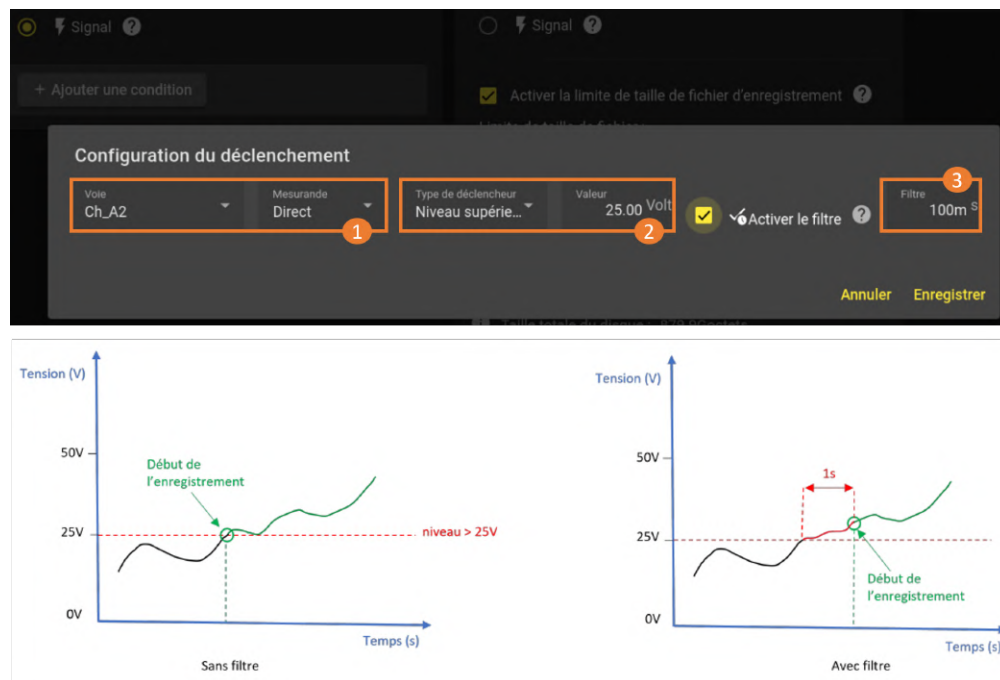
FIGURE 3.26 : Déclenchement sur niveau
