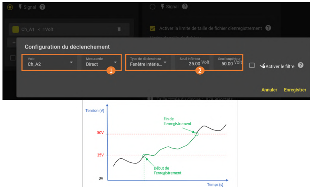
FIGURE 3.28 : Déclenchement sur fenêtre
