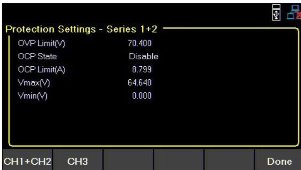
Image 18 : Menu Protection Setting en mode Series CH1+2
