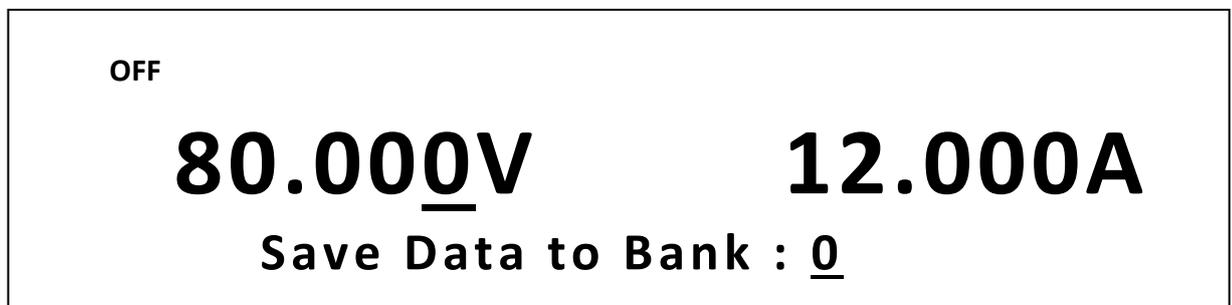
3. Utilisez le vernier d'ajustement du courant ou le pavé numérique pour entrer l'emplacement de mémoire dans lequel sauvegarder les réglages actuels de l'instrument. Sélectionnez entre 0-9. Appuyez sur
