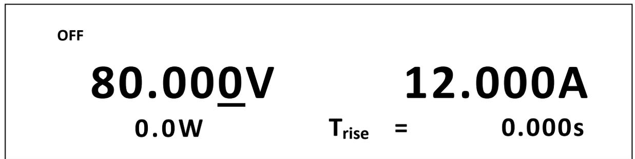
2.  $T_{rise}$  est le temps de front montant pour une transition de tension de sortie. Utilisez le pavé numérique ou le vernier d'ajustage du courant et entrez **5.000 s (5 secondes)**.
