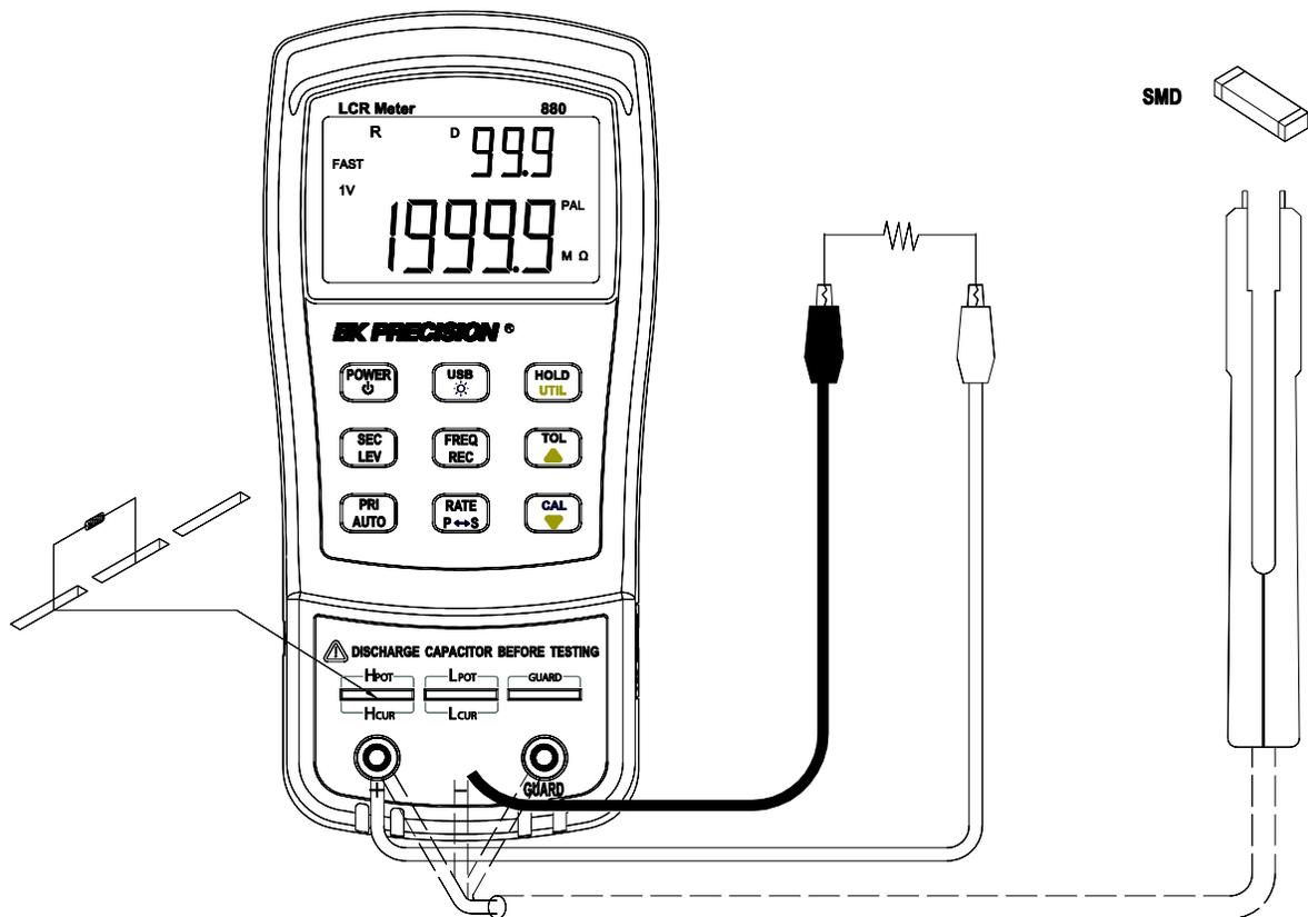
Schéma 13 – Mesure de résistance
