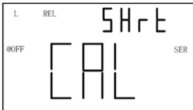
Figure 8 – calibration en court-circuit
