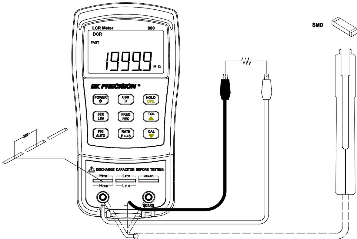
Schéma 14 – Mesure de la résistance en courant continu (DCR)
