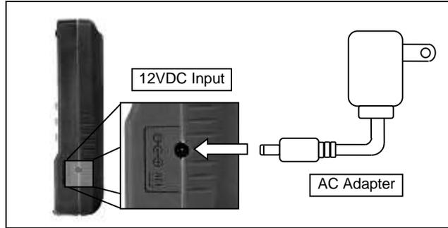
Schéma 6 – Connexion d'un adaptateur au pont RLC
