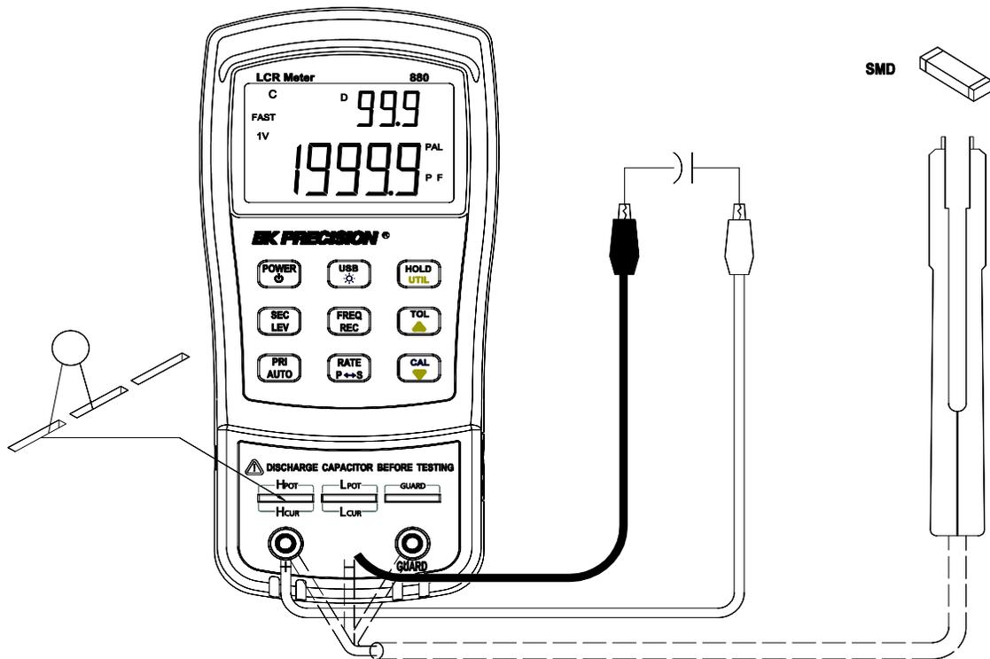
Schéma 12 – Mesure de capacité
