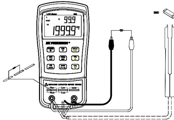
**Schéma 9 – Insertion des composants dans l'entrée**
