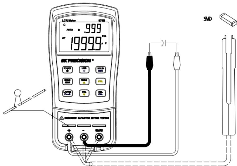
Schéma 11 –Mesures de capacité
