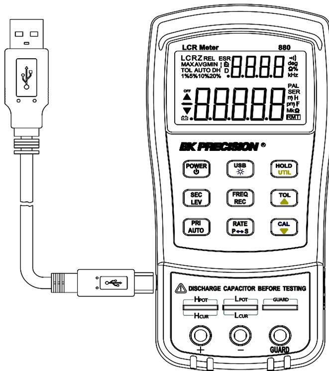
Schéma 16 – Connexion USB
