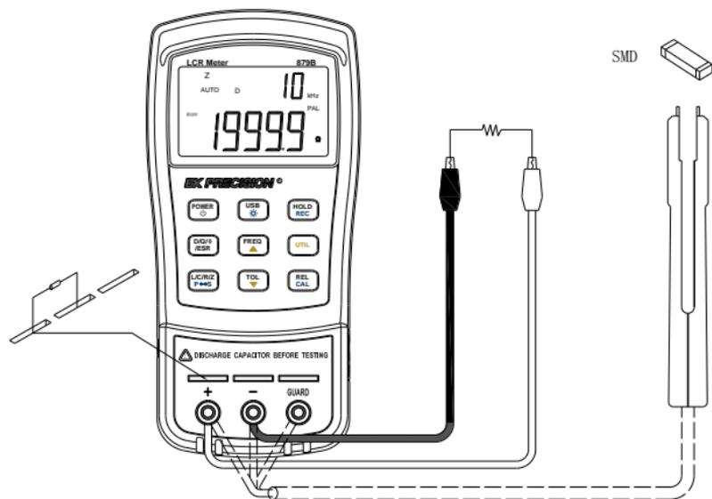
**Schéma 13 – réglage pour les mesures d'impédance**
