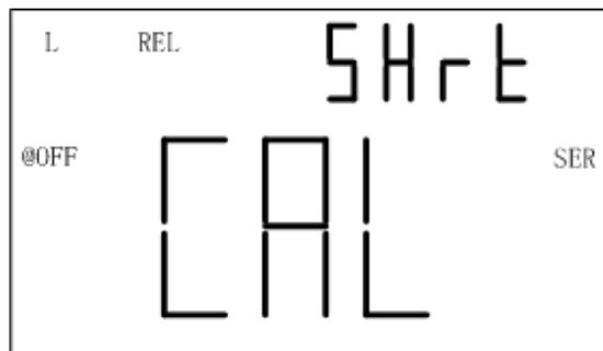
**Schéma 8 – Calibration en cours circuit**
