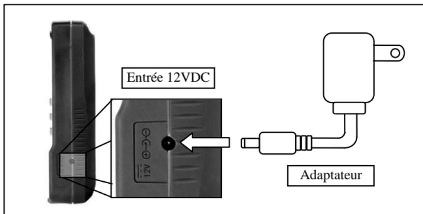
**Schéma 5 – Connexion d'un adaptateur à un mesureur**
