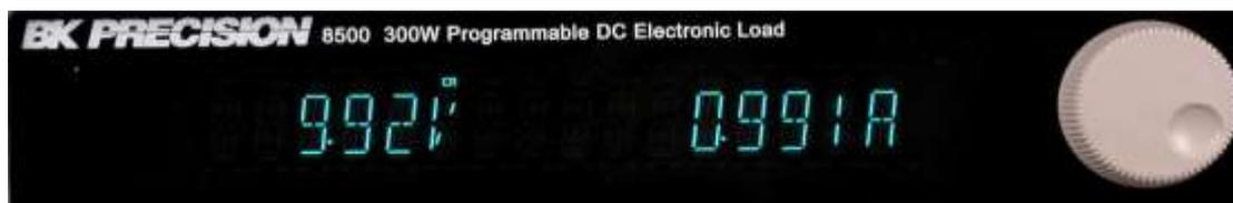
Il est possible que l’affichage de la tension de l’instrument indique un peu moins qu’à la sortie de l’alimentation. Ceci est peut-être dû à une chute de tension dans les câbles connectés reliant l’alimentation à la charge. Appuyer sur la touche ▲ ou ▼ pour voir la consommation de la charge.
