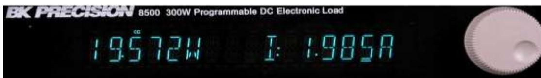
Appuyer sur le bouton **V-set** (vous pouvez appuyer deux fois). La charge est éteinte. Régler l’alimentation à 10 V et le courant d’alimentation à un niveau très bas, 0,1A par exemple. Régler la tension de la charge en-dessous du niveau de tension de l’alimentation, 1V par exemple. Appuyer sur la touche **On/Off**. Vérifier que le niveau de tension correct (1V) s’affiche. Appuyer sur la touche **n** ou **n** pour voir que la puissance est dissipée.
