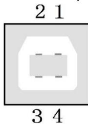
Cet instrument utilise une interface de type USB-B qui peut communiquer via un câble d'interface USB carré standard. Il n'y a pas de paramètres dans le système de menu pour la configuration USB. Le seul prérequis est qu'un pilote USBTMC soit installé. Un pilote USBTMC est inclus avec le logiciel VISA.
