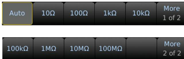
Appuyer sur Range pour sélectionner la plage. La plage automatique (Auto) sélectionne automatiquement la plage de mesure appropriée en fonction du signal d'entrée. La plage automatique est ajustée jusqu'à 110% au-dessus et jusqu'à 10% au-dessous de la plage existante.
