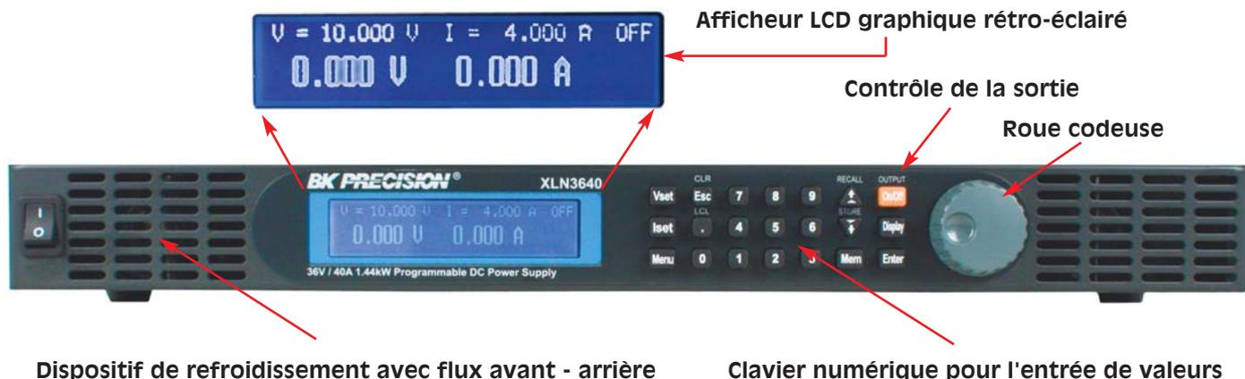
Le clavier numérique en face avant associé à la roue codeuse permet une programmation simple et rapide de l'alimentation. Le courant et la tension peuvent être réglés avec une résolution allant jusqu'à 1mV et 1mA. L'afficheur graphique indique en permanence les valeurs de consigne et les valeurs réelles de tension et de courant. Il est possible de mémoriser 10 configurations complètes et de les rappeler depuis le panneau avant ou en programmation à distance.
