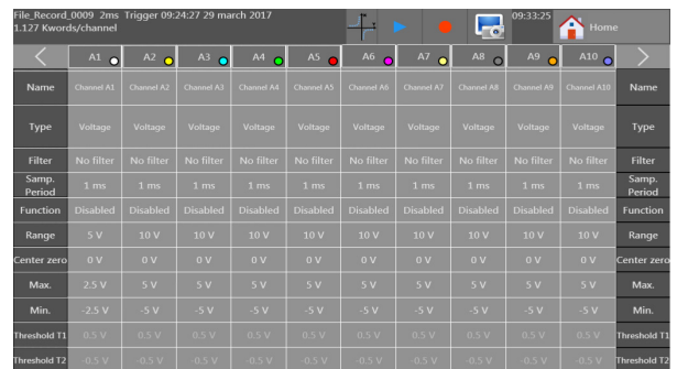
Le tableau de configuration des voies affiche tous les paramètres sur un seul écran
