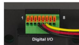
Le bornier d'E/S numérique à 8 broches préserve les broches de signalisation couramment utilisées, y compris les capacités d'inhibition à distance, d'activation du courant alternatif et de sortie de défaut en fonctionnement triphasé.
