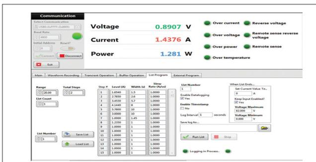
Le logiciel d'application sur PC permet l'émulation de la face avant ainsi que la programmation ou le transfert de données sans avoir à programmer. Il permet aussi de créer sans limite les fichiers utilisés dans le mode LIST, ceux-ci étant sauvegardés sur votre ordinateur.
