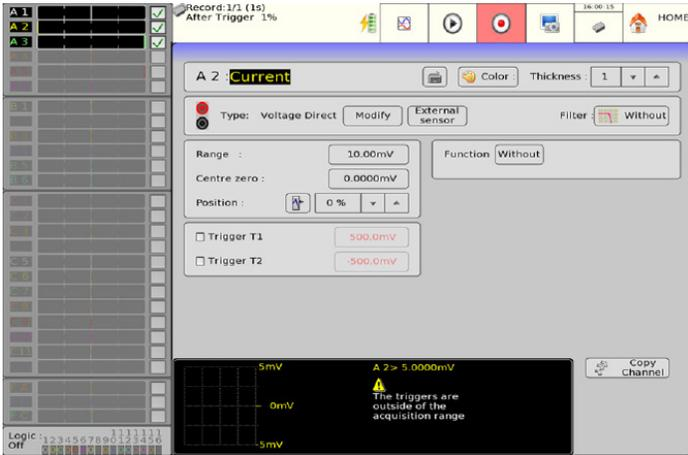
La configuration des voies permet d'afficher les paramètres de 12 voies au maximum sur un seul écran.
