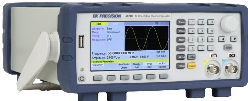
Les générateurs de formes d'ondes arbitraires de la série 4078C sont des générateurs de formes d'ondes arbitraires à deux voies, polyvalents et très performants, avec une résolution d'amplitude de 16 bits. Ils fournissent des tensions de sortie variables de 0 à 10 Vp-p sous 50 ohms, jusqu'à 20 Vc-c en circuit ouvert, et un offset DC variable pour polariser le signal de sortie au niveau désiré. un décalage CC variable en continu pour polariser le signal de sortie au niveau désiré.
