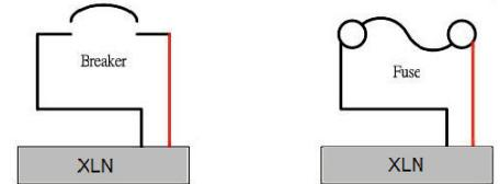
La Serie XLN puede ser usada para medir con precisión el tiempo en el cual un fusible o interruptor de circuito se abre. Luego que los niveles de voltaje y corriente están configurados, el botón On/Off activa la salida y el tiempo durante el cual el fusible/interruptor se abre es medido al 100  $\mu$ s más cercano. El tiempo máximo del período de conteo es de una hora.
