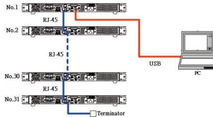
En el modo de control de unidad múltiple, hasta 31 unidades pueden ser conectadas en cadena vía RS485 y controladas desde una unidad maestra a través de las interfaces USB, GPIB, o LAN.
