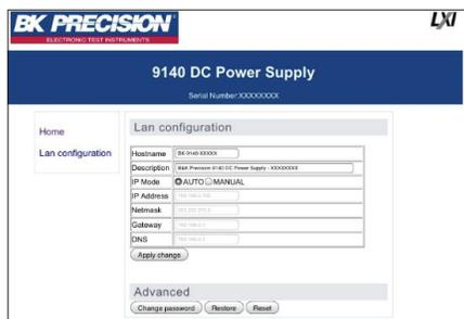
La Serie 9140 proporciona un servidor web integrado que permite a los usuarios ajustar la configuración LAN de la fuente de alimentación, desde un navegador web en una computadora.
