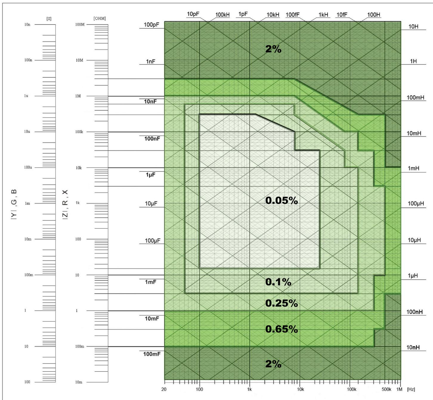
**Exactitud DCR:**  $A(1 + R_x / 5 \text{ M}\Omega + 16 \text{ m}\Omega / R_x)[\%] \pm 0.2 \text{ m}\Omega$ , para velocidad de medida lenta y média  $A=0.25$ , para velocidad rápida  $A=0.5$
