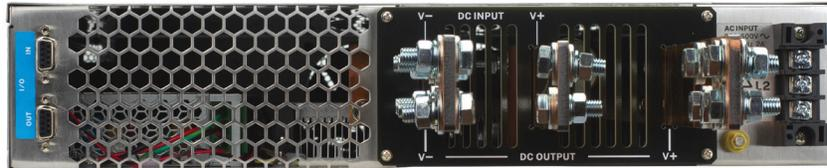
Al trabajar con motores, transformadores u otras cargas inductivas, las unidades de protección inversa de la serie HMRPU protegen su fuente de alimentación DC contra el voltaje inverso y el retroceso inductivo. La arquitectura de la unidad de protección consta de un diodo de bloqueo y un diodo de rueda libre (Figura 1) capaces de proteger varias fuentes de alimentación conectadas en paralelo. Es compatible con las fuentes de alimentación DC de las Series HMR, MR y HPS de B&K Precision.
