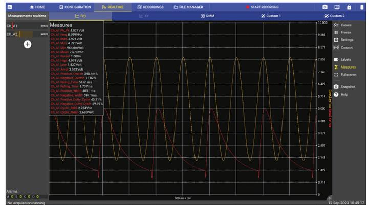
Calcule automáticamente hasta 19 mediciones de formas de ondas diferentes incluidas, amplitud, RMS, promedio, frecuencia, tiempo de subida/caída.
