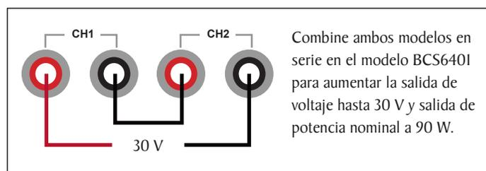
Combine ambos modelos en serie en el modelo BCS6401 para aumentar la salida de voltaje hasta 30 V y salida de potencia nominal a 90 W.
