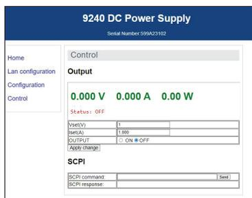
La Serie 9240 proporciona un servidor web integrado que permite al usuario configurar y controlar la configuración básica de la fuente de alimentación desde el navegador web de una computadora.
