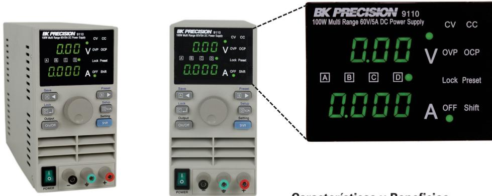
Los modelos 9110 y 9111 son un nuevo tipo de fuentes de alimentación, que a diferencia de las fuentes convencionales con rangos de salidas fijos, recalculan los límites de voltaje y corriente para cada puesta en marcha, ofreciendo cualquier combinación voltio/ampere dentro de su rango de poder. Al proporcionar extensas opciones de combinaciones dentro del poder máximo, el usuario puede reducir el número de fuentes de poder requeridas para liberar valioso espacio en su banco de trabajo.
