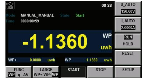
La función de integración es útil para analizar la energía eléctrica adquirida o proveída de sistemas de potencia de la red. El medidor 5335C provee funciones de corriente integral y potencia activa integral (Wh) utilizando la conmutación de rangos para resultados de mediciones más precisos.
