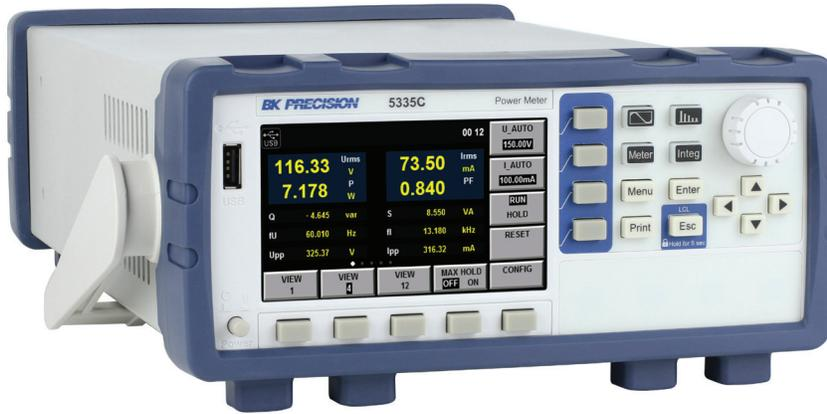
El Modelo 5335C de B&K Precision es un Medidor de Potencia AC/DC monofásico y compacto, para medir y analizar el consumo de potencia eléctrica, así como sus parámetros de calidad de manera rápida y precisa. Respaldar mediciones de potencia de hasta 600 Vrms y 20 Arms, con ancho de banda de hasta 100 kHz.
