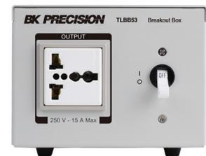
Esta caja de conexión universal Modelo TLBB53 simplifica la conexión de línea AC entre el medidor de potencia y el dispositivo en prueba, eliminando la necesidad de cortar el cable de alimentación y pelarlo para conectar el medidor de potencia. Esta caja facilita conexiones de entrada utilizando un enchufe universal que respalda la mayoría de los enchufes utilizados alrededor del mundo. Además provee un interruptor de cortocircuitos para brindar protección adicional.
