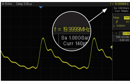
Formas de ondas arbitrarias verdaderas incorporadas a 20 MHz, 300 MSa/s
