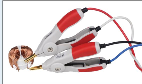
Mida la resistencia de los bobinados de un motor y un transformador, de los contactos del relé y el interruptor, y de otros materiales conductores y componentes. Incluye puntas de prueba Kelvin de 4 cables en ambos modelos.
