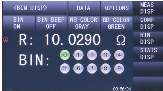
Sortee componentes con rapidéz utilizando los 10 bins del Modelo 284I o los 3 bins del Modelo 2840. Los resultados podrán ser visualizados en la pantalla o descargados por medio del manipulador mecánico (interfaz handler). Los límites altos y bajos de cada bin pueden ser configurados en los modos absoluto o de tolerancia.
