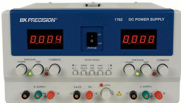
Las fuentes de alimentación DC de triple salida de la Serie 1760A ofrecen tres salidas independientes con perillas de ajuste de voltaje grueso y fino. La pantalla LED de 4 dígitos ofrece una resolución de 10 mV y 1 mA, la cual brinda la capacidad de configurar valores de voltaje y corriente con mayor precisión que las pantallas de 3 dígitos, halladas en la mayoría de las fuentes de alimentación comparables.
